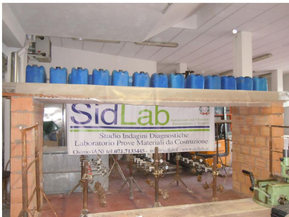
*Foto n. 12 – Fase di carico con serbatoi riempiti d'acqua del sistema X Plaster W-System*
