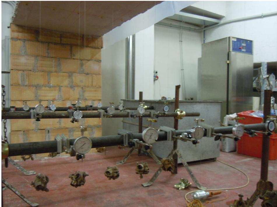
*Foto n. 9 – Disposizione degli strumenti di misura all'intradosso del sistema anti-sfondellamento*
