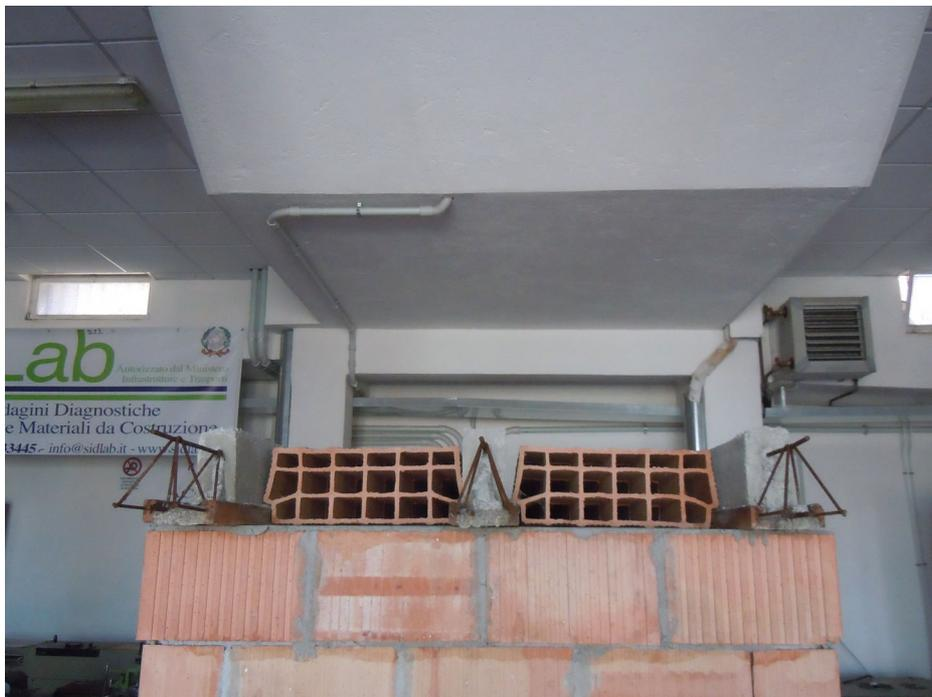
*Foto n. 2 – Fase costruttiva della striscia di solaio*
