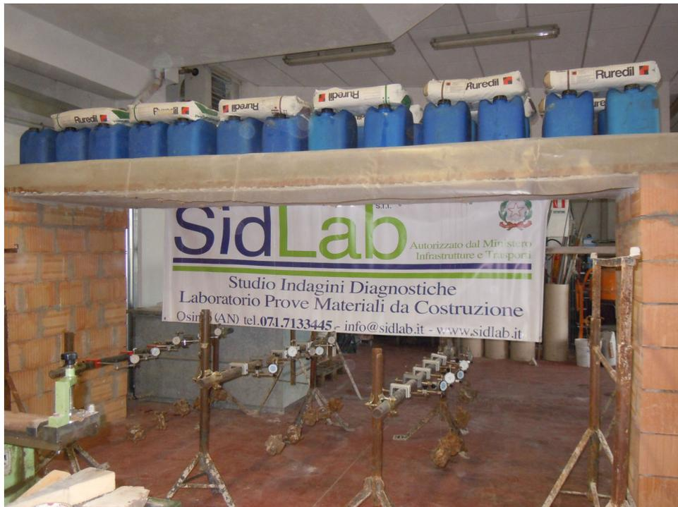
*Foto n. 13 – Fase di carico massimo del sistema X Plaster W-System*
