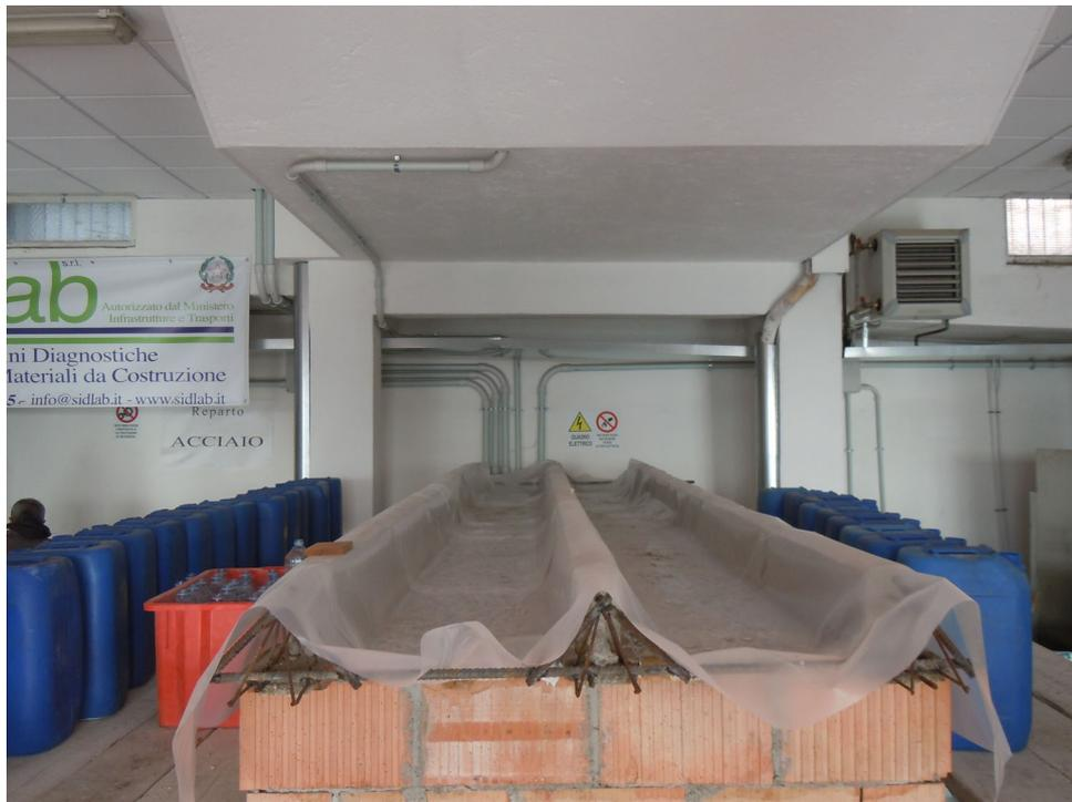
*Foto n. 11 – Preparazione del piano di posa del carico di prova dopo rimozione delle pignatte*
