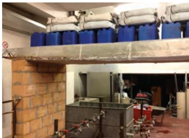
Prova di carico sistema X Plaster sino a  $300 \text{ kg/m}^2$ .
