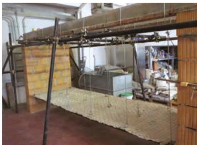
Prova di carico del sistema X-PLASTER appeso con un sistema di pendini al solaio esistente.
