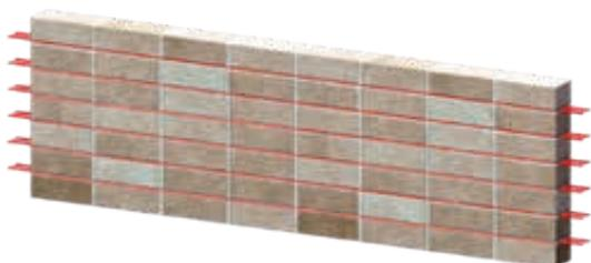
Per pareti architettoniche realizzate con giunti allineati (o "a sorella") l'utilizzo di rinforzi orizzontali con Murfor (interasse  $\leq 300$  mm) permette di **aumentarne la resistenza flessionale rendendola equivalente a quella di una tamponatura a giunti sfalsati**.
